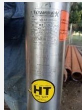
Adquisición de Motor Altamira X 50 Hp, 460 V, Bomba sumergible Altamira KOR15 R500/14 .
